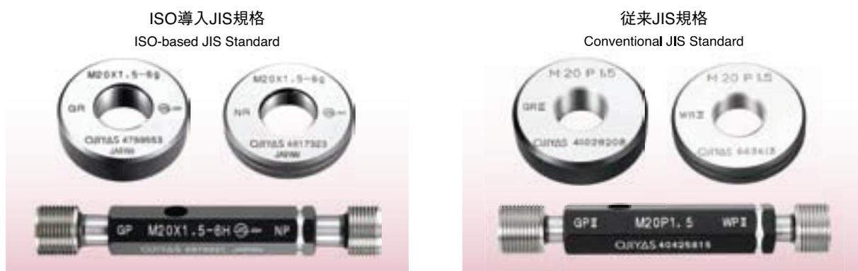
メートルねじ、ユニファイねじ、自転車ねじ、ミシンねじ等、種々のねじに対応したねじ用限界ゲージをお使い下さい。限界方式は大きく分けてISO導入JIS規格と従来JIS規格（検査用・工作用）があります。
